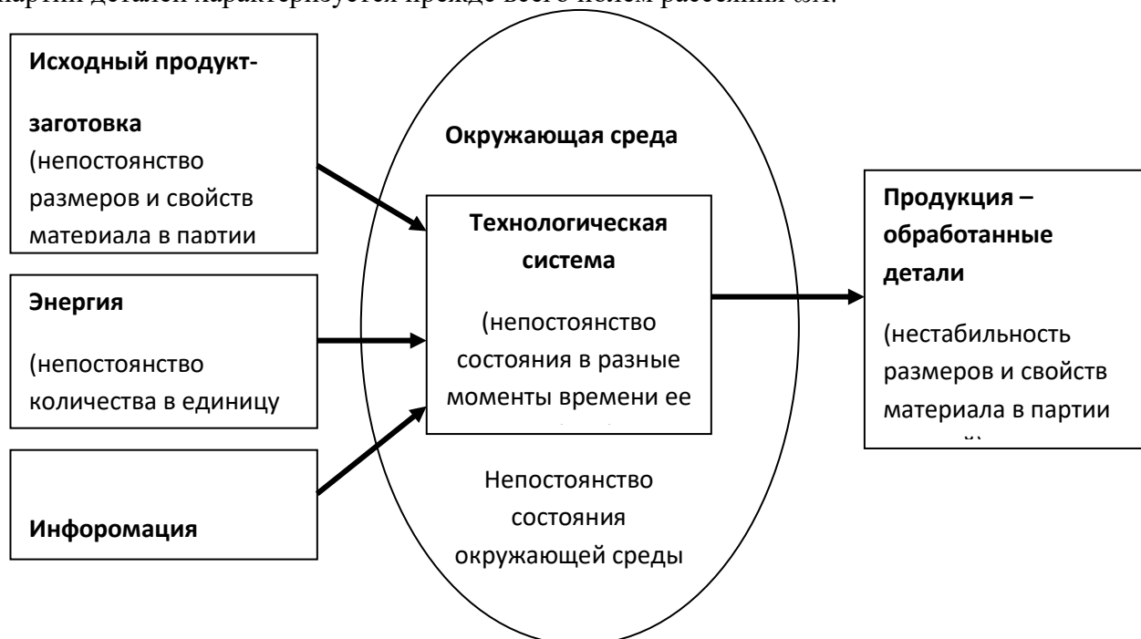
Рис. 2.1. Схема образования нестабильности результата производственного процесса из-за непостоянства условий его реализации
